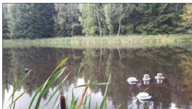
Figur 1. Venstre: Måling af CO 2 -udvekslingen på en skovdam i Gribskov med flydekamre i forskellige udformninger, til venstre i billedet ses boksen med datalogger som gemmer målinger af vandets pH hvert 10. minut. Højre: Automatisk flydekammer til måling af CO 2 -udvekslingen på søer og damme /2/.
