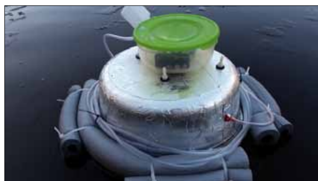
Figur 1. Venstre: Måling af CO 2 -udvekslingen på en skovdam i Gribskov med flydekamre i forskellige udformninger, til venstre i billedet ses boksen med datalogger som gemmer målinger af vandets pH hvert 10. minut. Højre: Automatisk flydekammer til måling af CO 2 -udvekslingen på søer og damme /2/.
